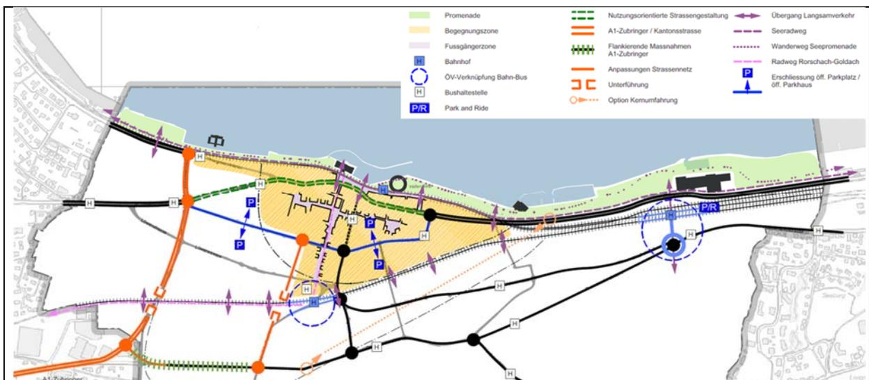
Abb.6: Konzeptbaustein „Stadt-Mobilität“: zwei Bahnunterführungen, Option Kernumfahrung; Quelle: STEK Rorschach<sup>11</sup>
